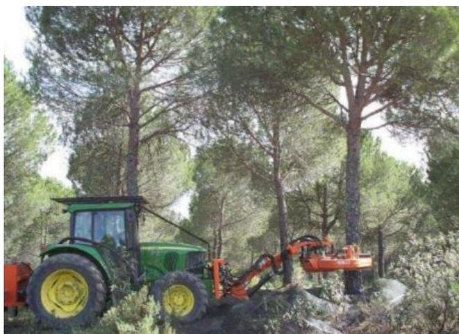
Photo 2. Tracteur agricole avec protections et tête vibrante intégrée.
